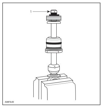
1. Damper shaft nut torque 11-13 N•m (96-108 lbf•in)
