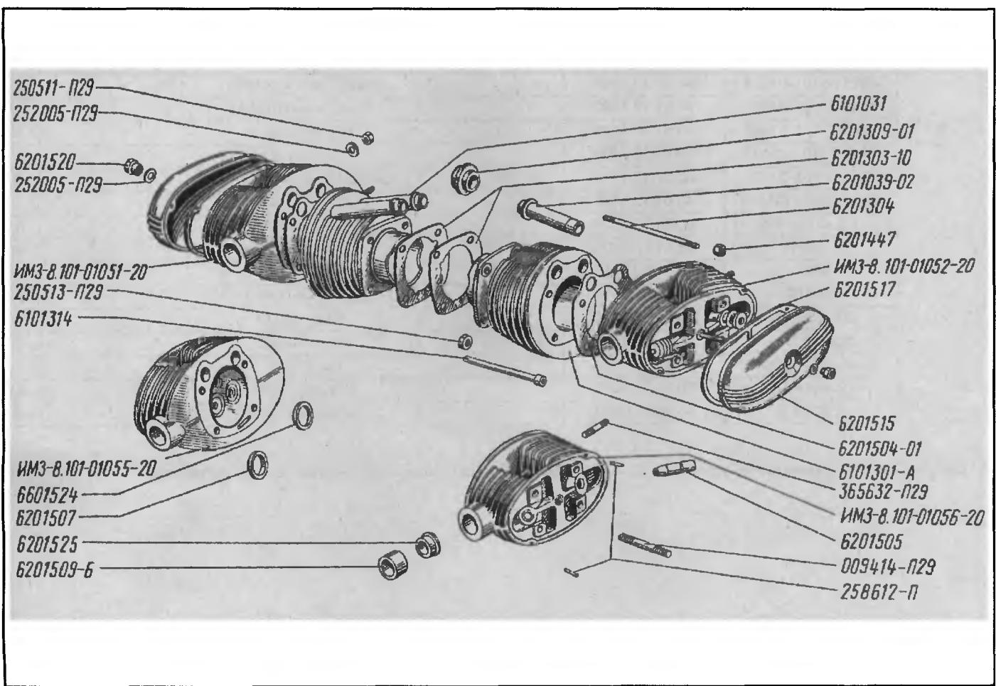
Цилиндры и головки цилиндров. Рис. 12
