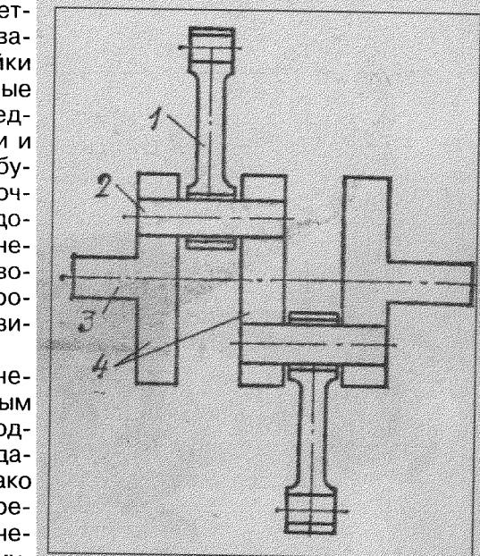
Рис. 5. Схема устройства кривошипно-шатунного механизма:
