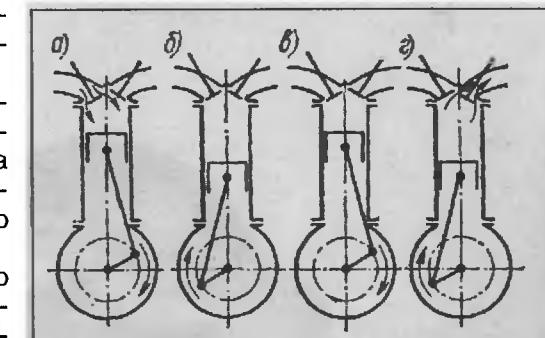
Рис. 2. Схема работы четырехтактного двигателя:
