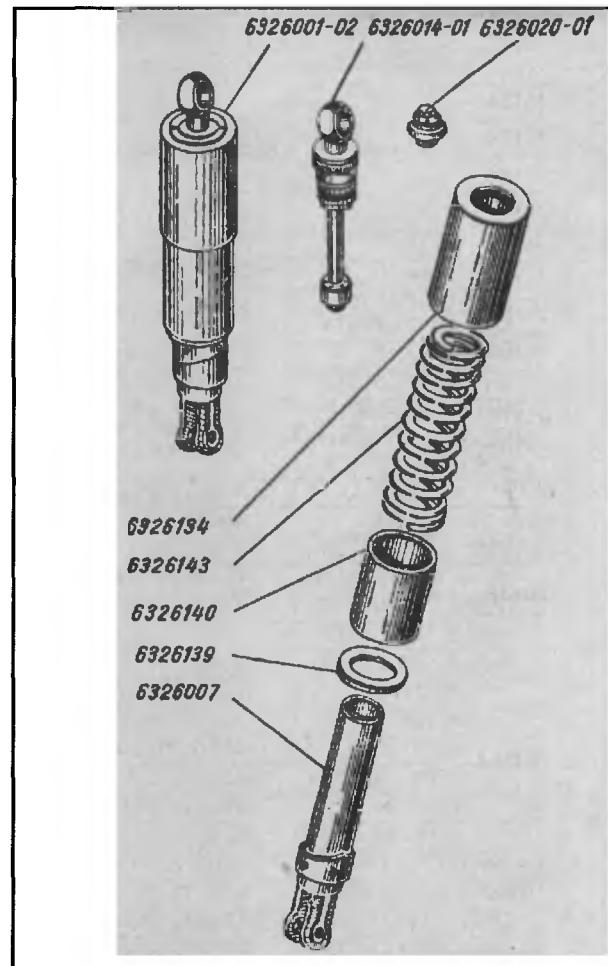
Пружинно-гидравлический амортизатор. Рис.8
