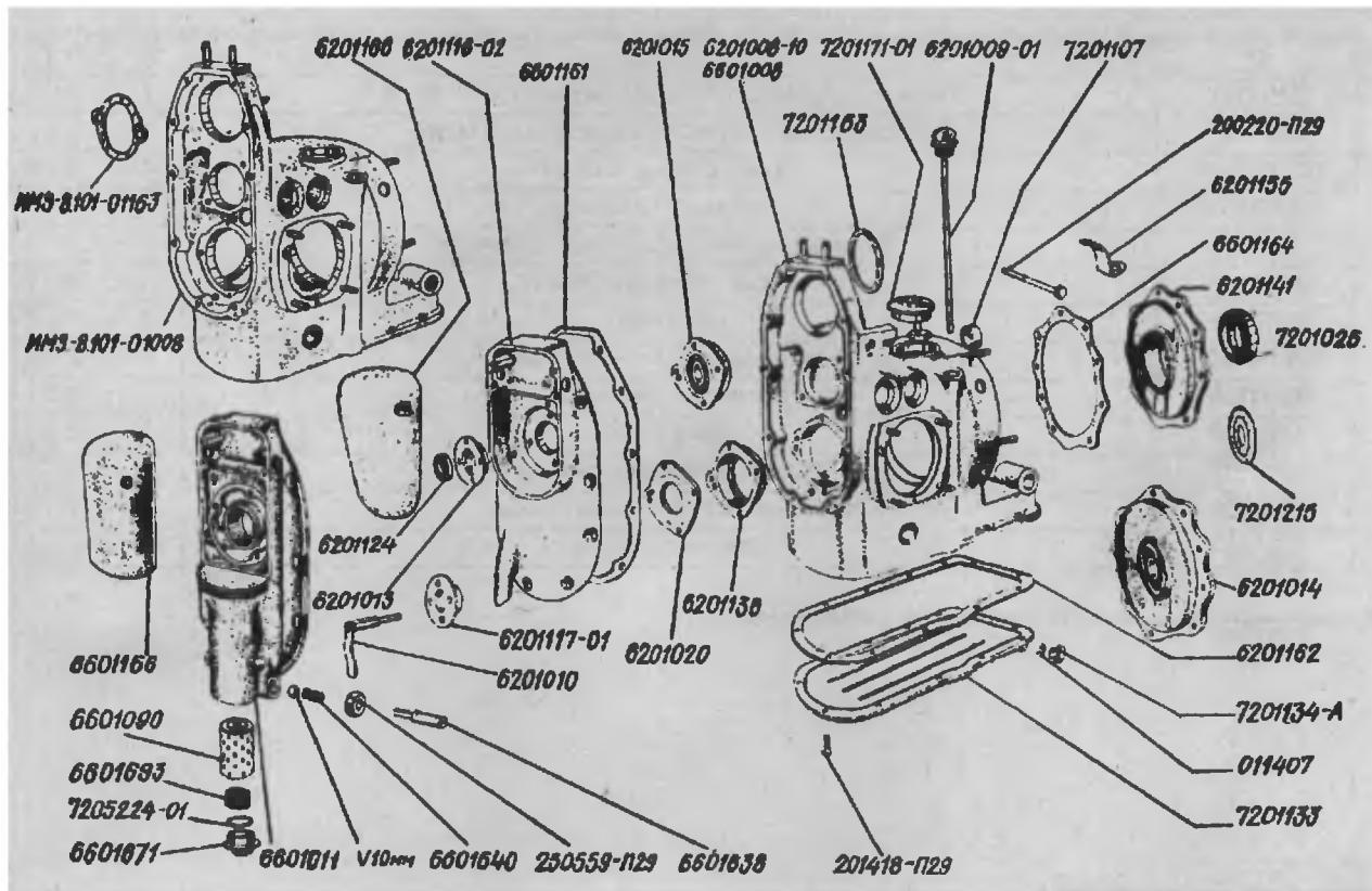
Картер двигателя с крышками и поддоном. Рис. 1
