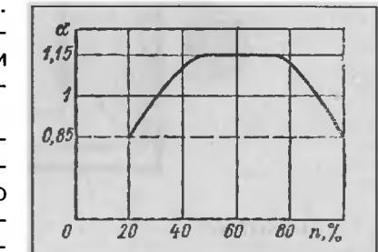
Рис. 13. Характеристика идеального карбюратора:  $\alpha$  - коэффициент избытка воздуха,  $n$  - частота вращения коленчатого зала
