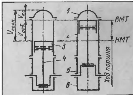
Рис. 1. Схема устройства четырехтактного двигателя:
