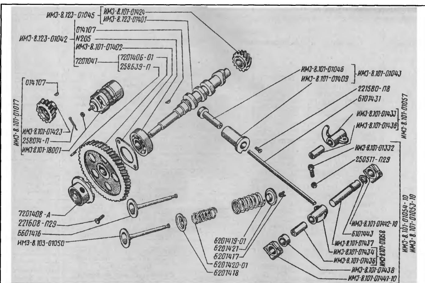
Механизм газораспределения. Рис. 13
