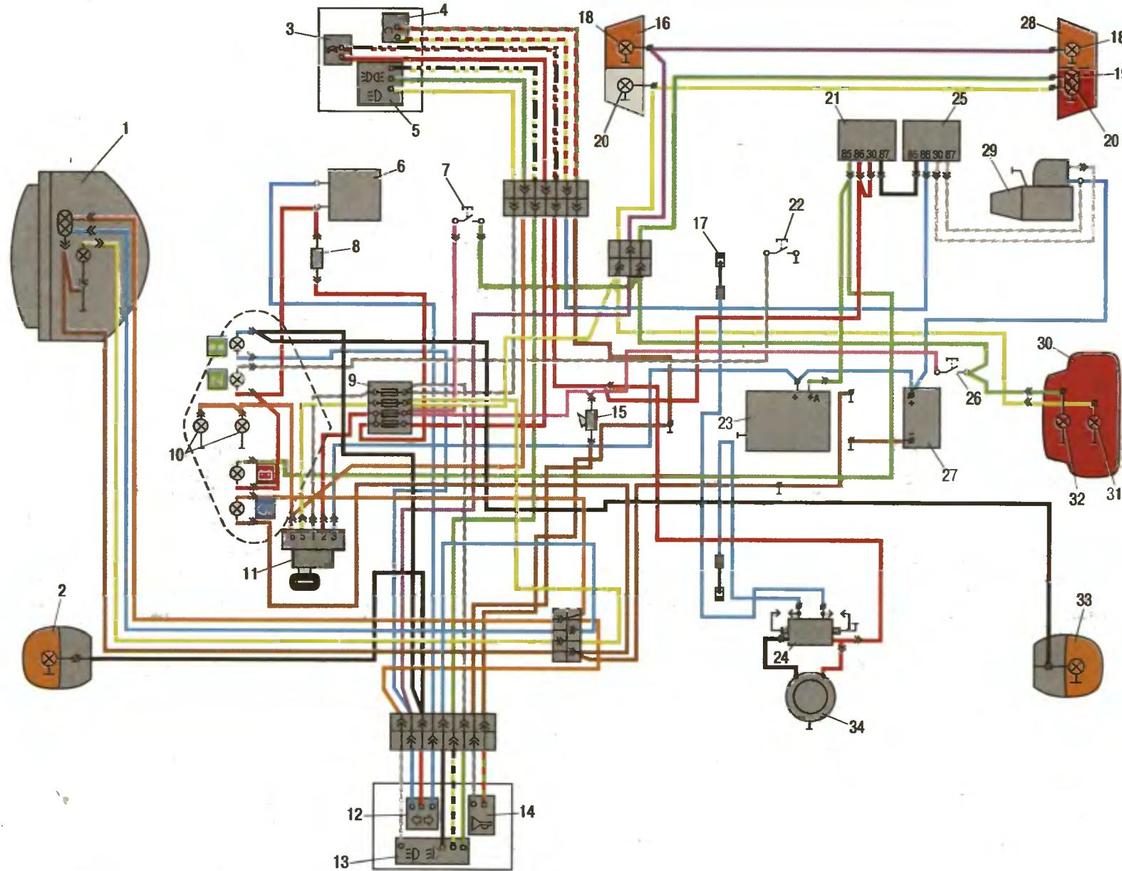
Схема электрооборудования мотоцикла ИМЗ-8.7037 и его модификаций (включая мотоциклы с приводом на колеса коляски):
