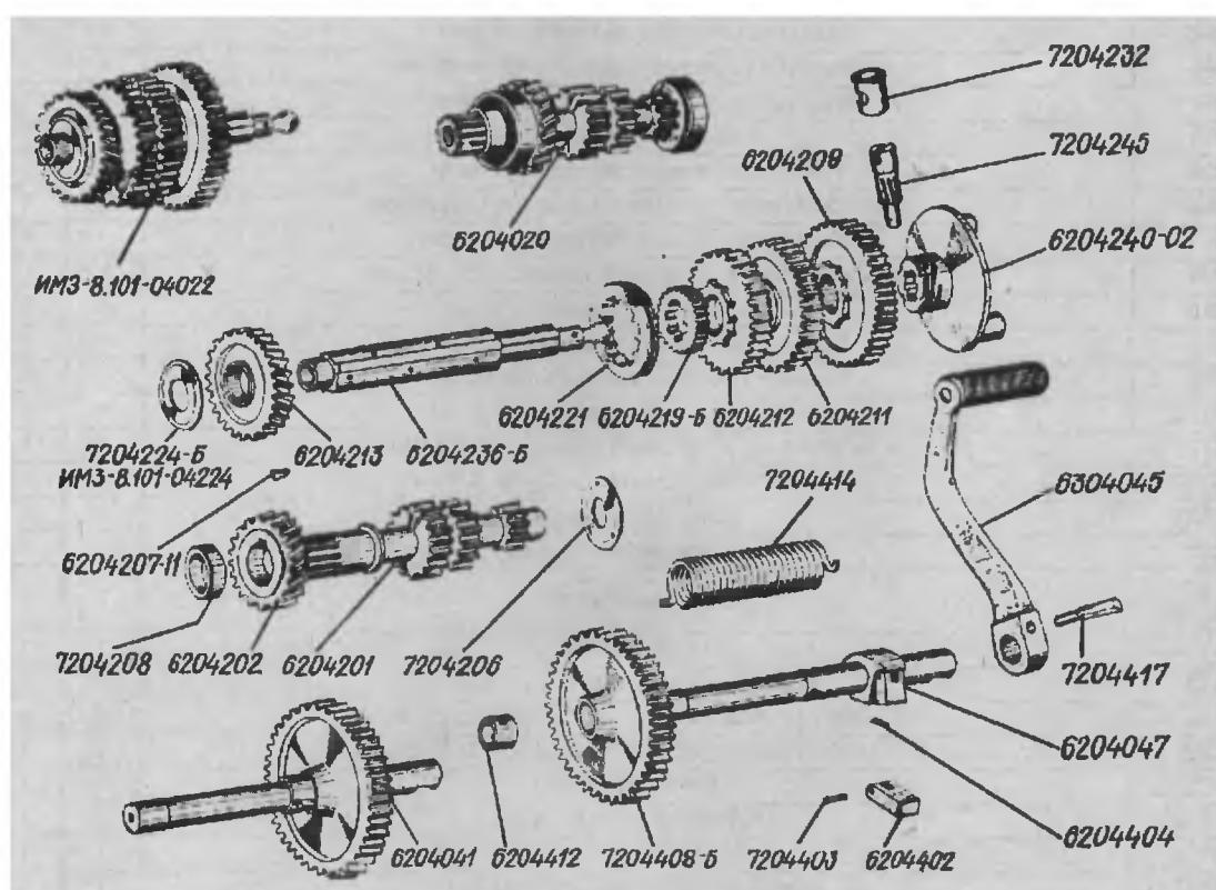
Валы и шестерни коробки передач. Рис. 6
