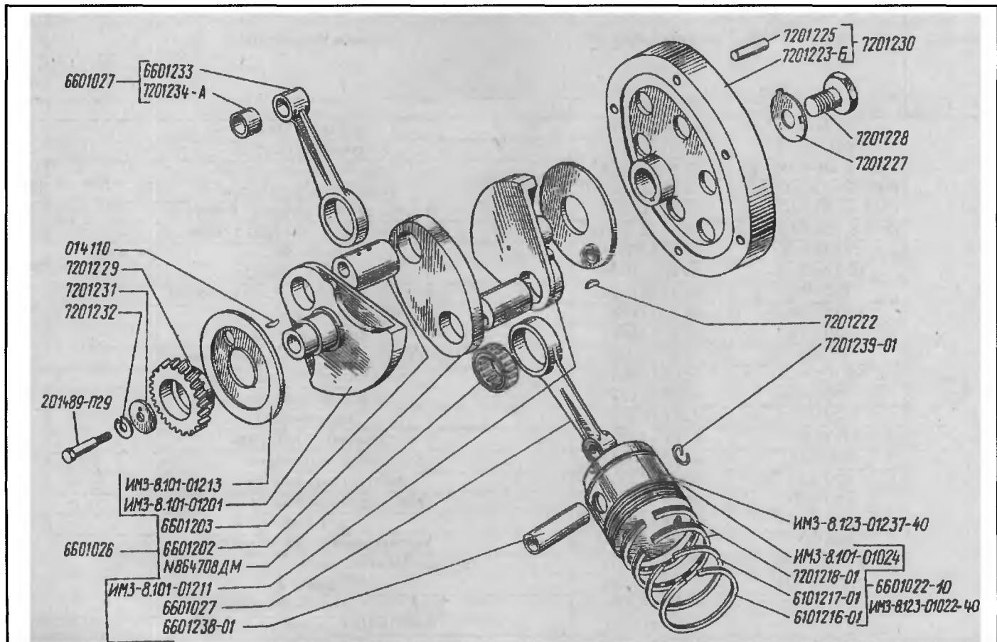
Коленчатый вал с шатунами и поршнями. Рис. 11
