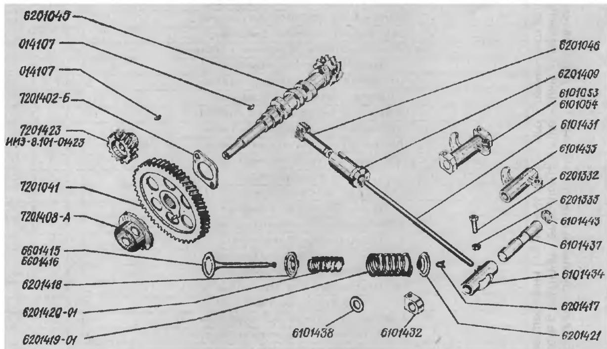
Механизм газораспределения. Рис.4
