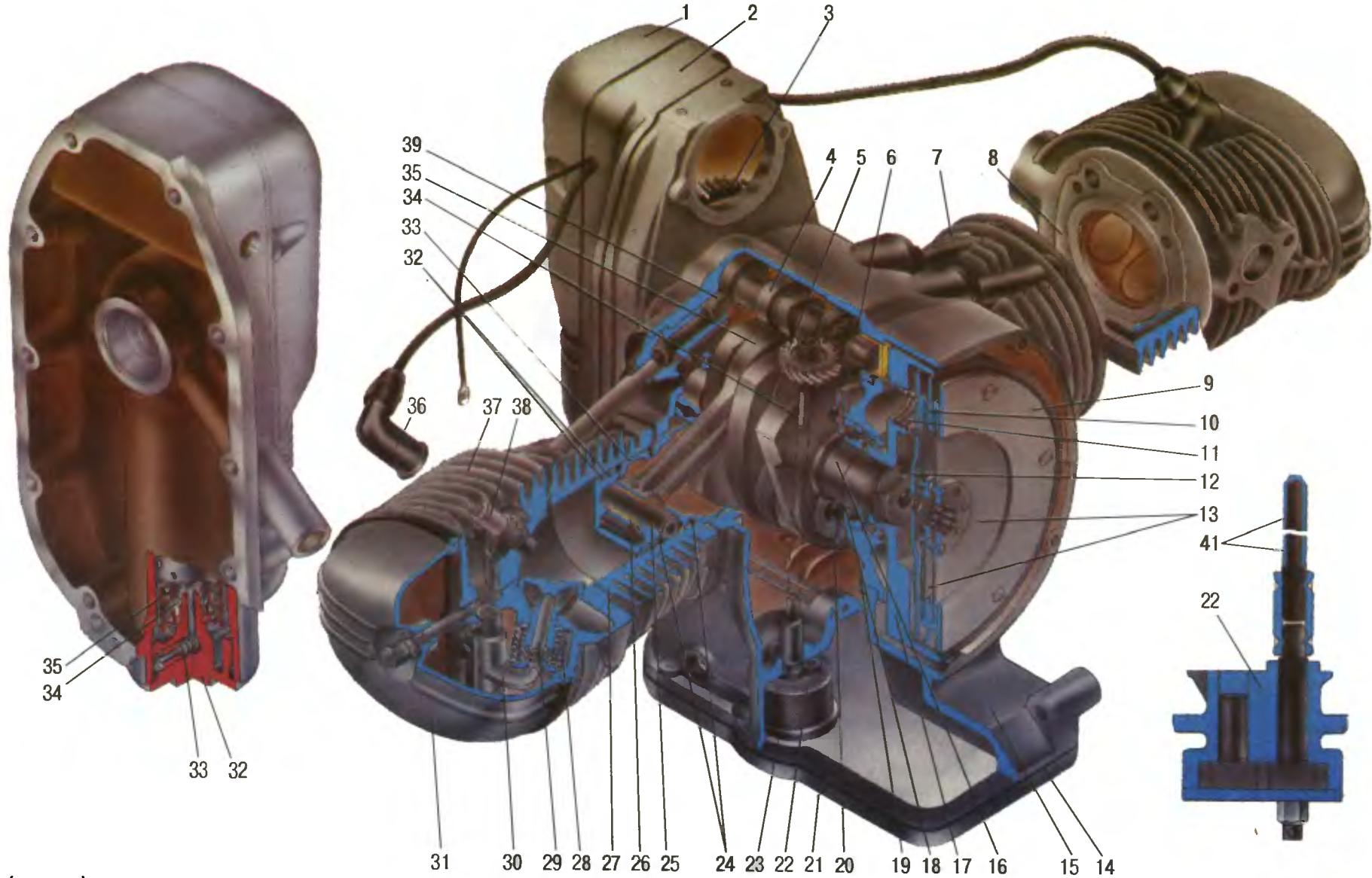
**Двигатель (вид сзади):**
