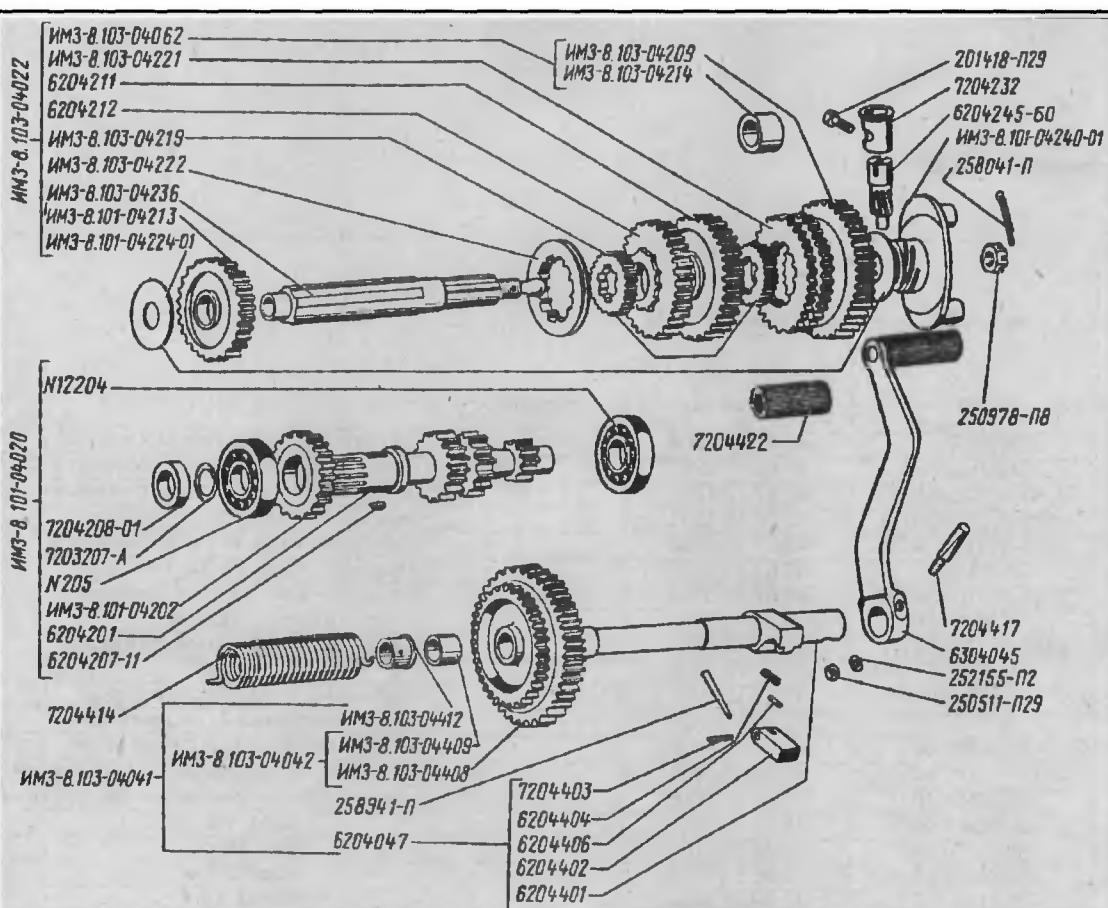
Валы и шестерни коробки передач. Рис. 14
