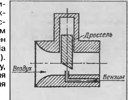
Рис. 14. Устройство простейшего карбюратора
